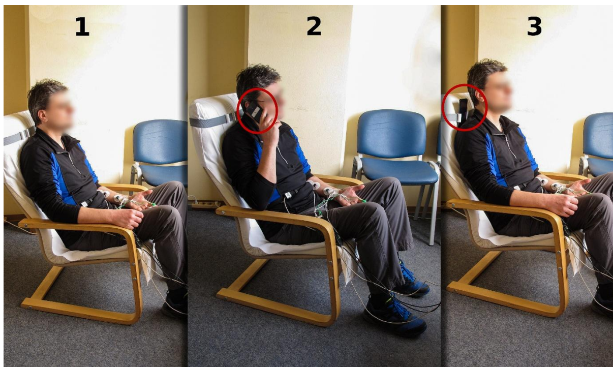
Slika 2: Situacija ispitivanja u sve tri faze: (1) priprema, (2) pozivanje i (3) faza pripravnosti Položaj mobilnog telefona tijekom poziva i faze pripravnosti označen je crvenim prstenom.
